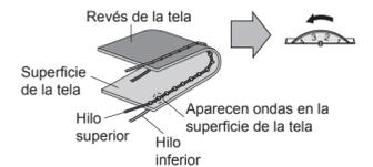
**Solución:** Reduzca la tensión girando el disco de control de la tensión superior a un número inferior.
