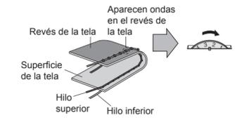
**Solución:** Aumente la tensión girando el disco de control de la tensión superior a un número superior.
