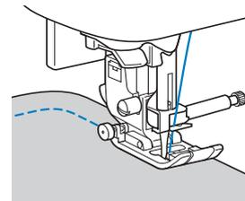
Cuando cosa a lo largo de una curva utilizando una puntada de zigzag, seleccione una longitud de puntada más corta para que la puntada sea más fina.
