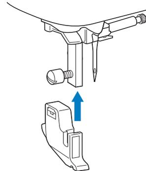
**3** Mantenga el soporte del pie prensatela en su lugar con la mano derecha y, a continuación, apriete el tornillo con la mano izquierda utilizando el destornillador.
