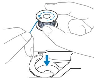
Si ha colocado la bobina con el hilo desenrollándose en la dirección equivocada, la costura se hará con una tensión del hilo incorrecta.
