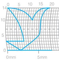
Dibuje el patrón como una línea continua, colocando el punto inicial y el final del diseño a la misma altura.
