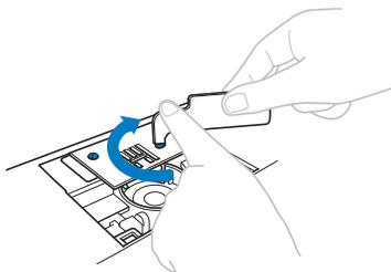
Gire la polea para comprobar que los dientes de arrastre se mueven fácilmente y no tocan los bordes de las ranuras de la placa de la aguja.
