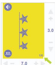
A continuación, entre en modo de costura Combo. La pantalla mostrará la puntada de la primera posición Combo. En el lado derecho, aparece el dibujo actual / todo el dibujo. Pulse el botón de arranque/parada o pise el controlador de pedal para empezar a coser.
