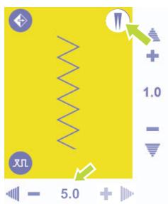
Pulse el botón. En la pantalla de LCD, aparecerá el símbolo de la aguja doble y la máquina reducirá automáticamente la anchura máxima a 2 mm para coser con aguja doble.
