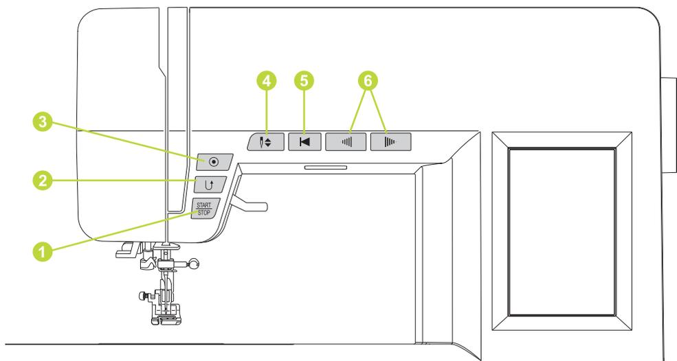
**1. Boton de arranque/parada** La máquina empezará a funcionar cuando se pulse el botón de arranque/parada y se parará cuando vuelva a pulsarse. La máquina girará lentamente al comenzar la labor.
