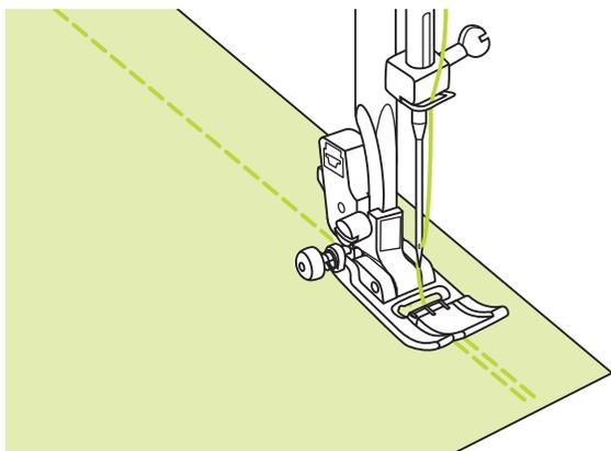
Las puntadas hacia atrás sirven para fijar los hilos al principio y al final de una costura. Pulse el botón de retroceso y cosa 4-5 puntadas. La máquina coserá hacia adelante cuando suelte el botón.
