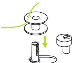
4. Introduzca el extremo del hilo por uno de los orificios interiores de la canilla, tal y como se muestra en la imagen, y coloque la canilla vacía en el eje.
