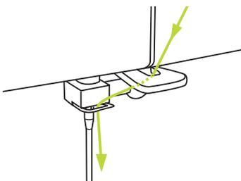
7. Pase el hilo por detrás del guía-hilos horizontal y plano. Guíe el hilo por el anillo.
