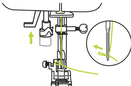
Sujete suavemente el hilo y suelte la palanca lentamente.
