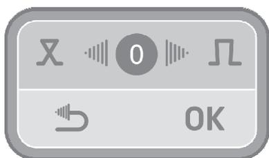
Después de elegir el dibujo de puntada, pulse el botón de ajuste de dibujos de puntada para entrar en la pantalla. Pulse los botones de la flecha derecha o izquierda para cambiar los valores y, posteriormente, pulse "OK" para guardar el ajuste. Este ajuste quedará guardado aunque apague la máquina. Pulse el botón de "retroceso" para salir del menú sin guardar los valores modificados.
