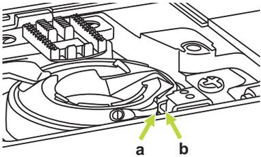
Vuelva a colocar el portacanillas en el carril de la lanzadera para que la punta (a) encaje en el tope (b) tal y como se muestra en la imagen.
