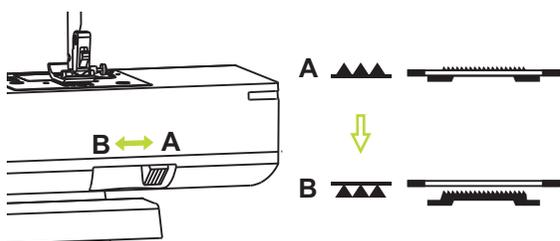
Deslice la palanca a (B) para bajar el transporte de dientes, por ejemplo, cuando cose botones.
