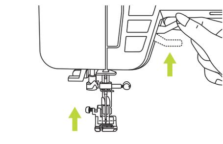
Cuando se cosen varias capas o telas gruesas, puede elevarse el prensatelas a un segundo nivel para colocar fácilmente la labor.
