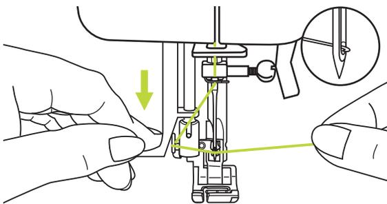
El enhebrador de la aguja se coloca automáticamente en la posición de enhebrado y el pasador de la lanzadera pasa por el ojo de la aguja.
