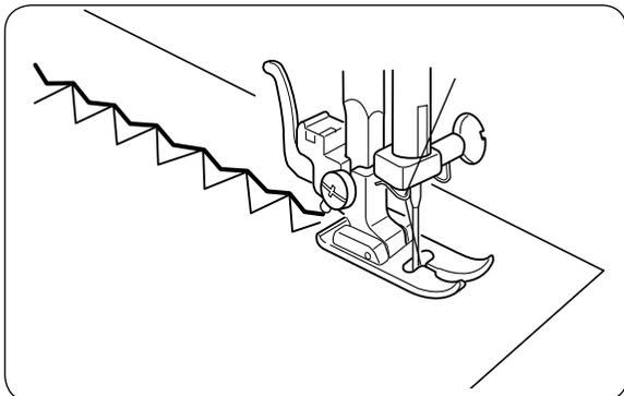
Si los alimentadores de avance y retroceso se desequilibran debido al tipo de tela, ajuste el equilibrio girando el botón selector de longitud de puntada de la siguiente forma:
