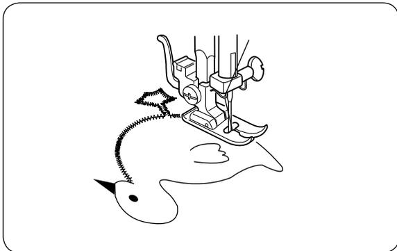
Hilvane (o fusione con un adhesivo térmico para telas) las piezas de la aplicación a la tela.
