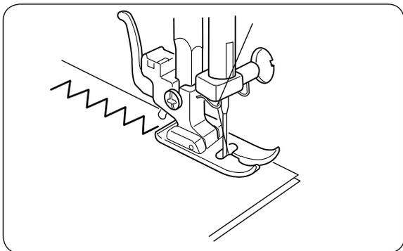
Las puntadas en zigzag simple se utilizan ampliamente para sobrehilar, coser botones, etc.
