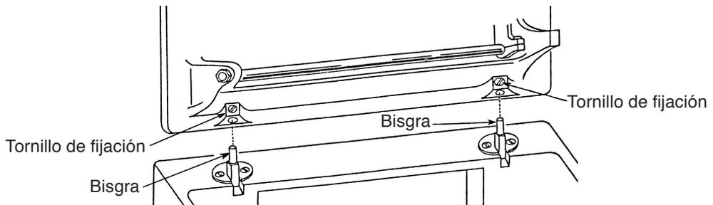
Vista inferior de la máquina, mostrando la posición de los tornillos de fijación
